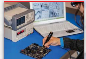
ใช้ตรวจสอบแผงวงจรที่ใช้ คิบบอกปรณ์ SMD ได้สะดวกกว่า
