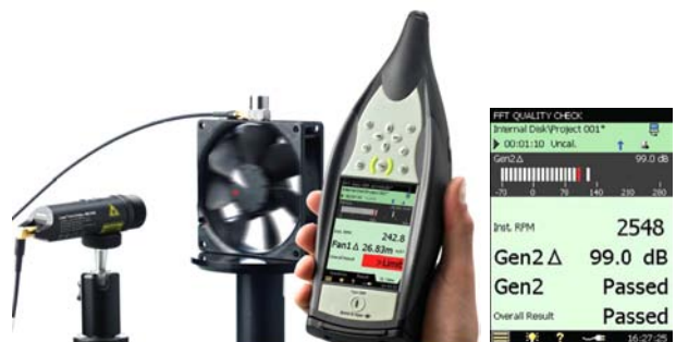
รูปที่ 3 การวัด Vibration ไปพร้อมกับ RPM แล้วแสดงผลค่า RPM, ค่า Vibration ที่วัดได้, ผลการเปรียบเทียบกับค่าอ้างอิง แล้วแสดงผล Pass/Fail เบ็ดเสร็จในหน้าจอเดียว
